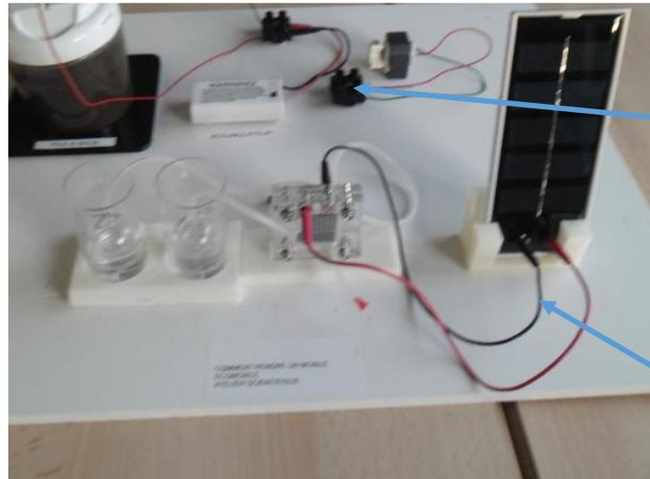
Chargement de l'accumulateur par la pile à boue
