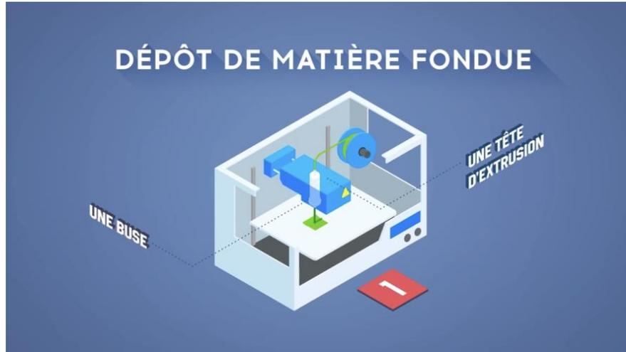
La matière est chauffée par la tête d'extrusion et distribuée en couches par la buse. Quand la température baisse, la matière se solidifie.
