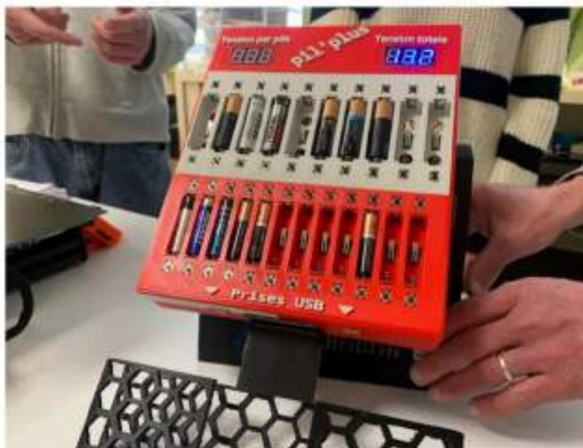
La Pile plus contient 22 emplacements pour des piles et deux ports USB pour charger des appareils électroniques. © Radio France - Marie-Antoinette Guiguen
