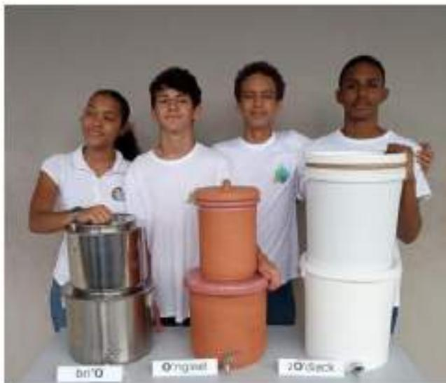
Les trois prototypes de filtre à eau par gravité à médias séparés. Le modèle O'riginel, en terre cuite et d'une capacité de 10 litres, permet de fournir de l'eau quotidiennement à une famille de 4 personnes. Le modèle bri'O en inox dispose d'un réservoir de 15 litres, le modèle zO'diack en plastique recyclé présente un réservoir de 20 litres et est notamment dédié aux situations d'urgence. Crédits : Science factor / Madin'O.
