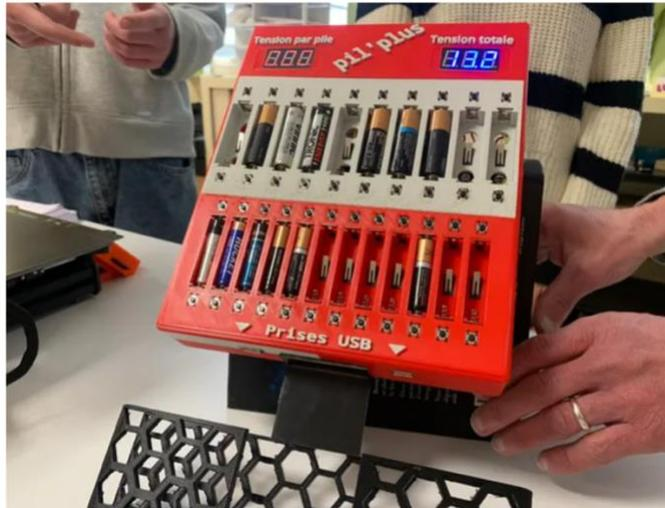
Le Pil'plus contient 22 emplacements pour des piles et deux ports USB pour charger des appareils électroniques. © Radio France - Marie-Astrid Guégan
